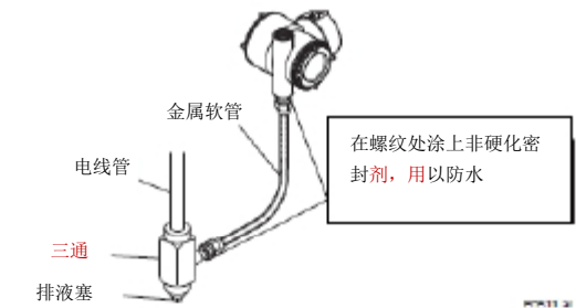
图 5.10 典型金属软管配线
