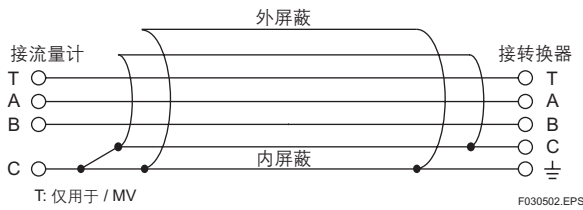
图3.4 分离型信号电缆结构
